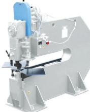
Ножницы высечные модели НК4516 предназначены для прямой и фасонной резки листового металла. На ножницах выполняют отбортовку, зиговку, фланжировку, гибку краев, прорезку жалюзи.
