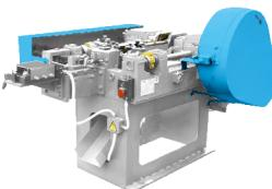
Автомат проволочно-гвоздильный АГ4116 предназначен для изготовления гвоздей по ГОСТ 4028-63 и ГОСТ 4034-63 с конической головкой из светлой низкоуглеродистой стальной проволоки по ГОСТ 3282-74 с временным сопротивлением сжатию  $\sigma_b \leq 50$  кг/мм.
